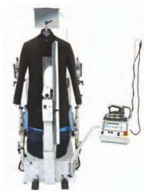
Манекен Princess Ultra мгновенно превращается в пароманекен с натяжением благодаря патентованному поворотному переднему зажиму, который переключается с горячего пресса на мягкий зажим.
