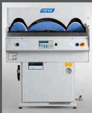
Исполнение либо с подключением к центральному паропроводу, либо со встроенным парогенератором мощностью 30 кВт для питания и парового манекена. Такое решение идеально подходит для быстрого оказания специализированных услуг по отделке сорочек в любом месте.
