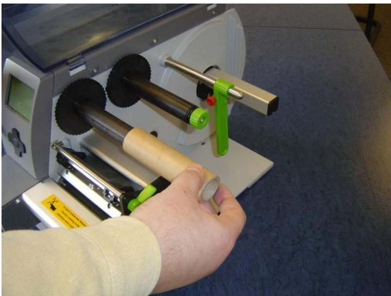
Удерживая черную часть стержня-держателя левой рукой, повернуть зеленое колесико против часовой стрелки и зафиксировать втулку.
