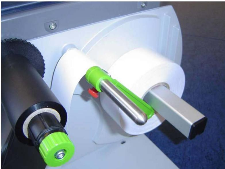
Проложить конец ленты под нижней осью через отверстие в корпусе печатающей головки.
