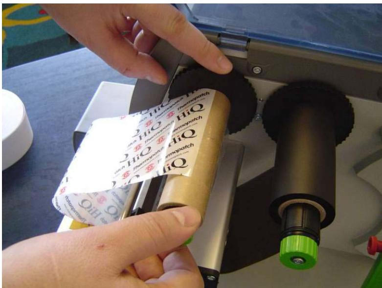
Вращая переднюю втулку против часовой стрелки, наматывать на нее ленту до тех пор, пока не будет достигнута показанная на рисунке ниже позиция.
