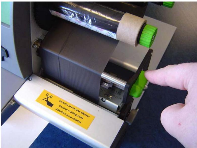
После закрытия печатающей головки передвинуть красную направляющую к краю ленты так, чтобы лента располагалась вдоль прямой линии.
